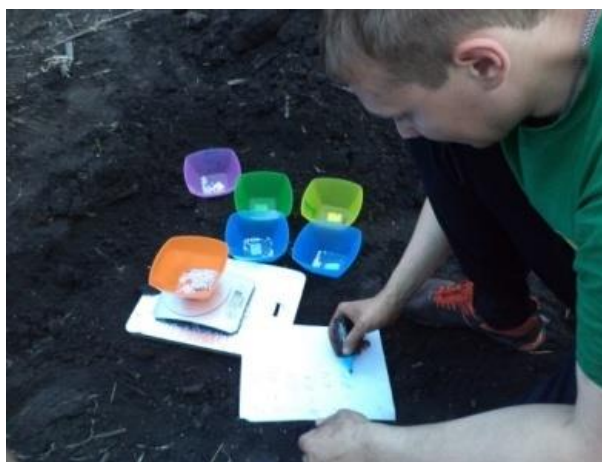
Рисунок 3.9 – Измерение массы образца пробы, полученной при послойном дифференцированном распределении удобрений
