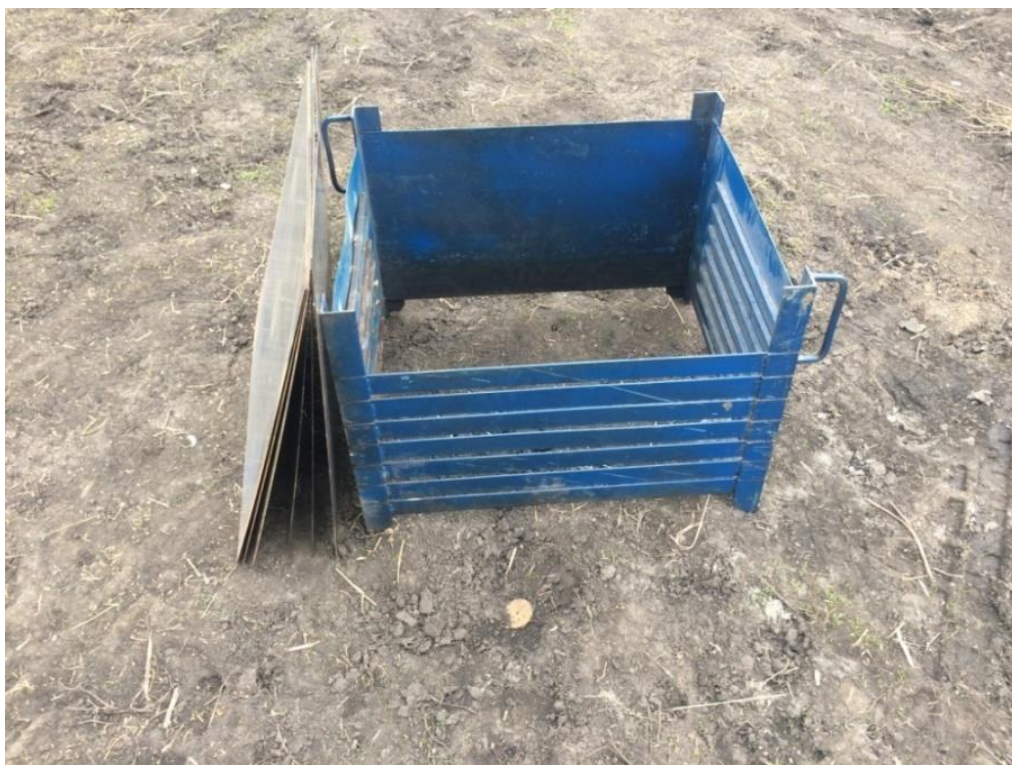
Рисунок 3.7 – Лабораторная установка для определения послойного распределения минеральных удобрений по слоям
