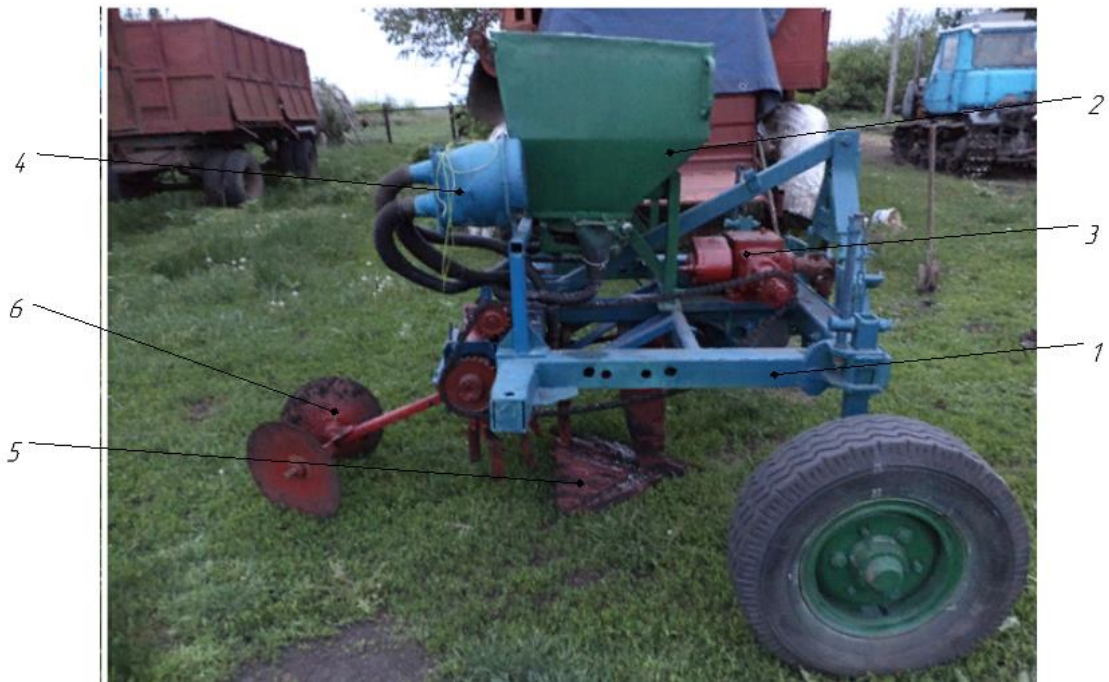
Рисунок 3.2 – Основные элементы конструкции агрегата для формирования гребневидного почвенного фона с дифференцированным распределением минеральных удобрений: 1 – рама с опорно-приводными колесами; 2 – бункер для минеральных удобрений; 3 – редуктор; 4 – вентилятор; 5 – клинообразная стойка, на которой установлен башмак с лемехами, долотом и отвальными поверхностями; 6 – дисковые окучники
