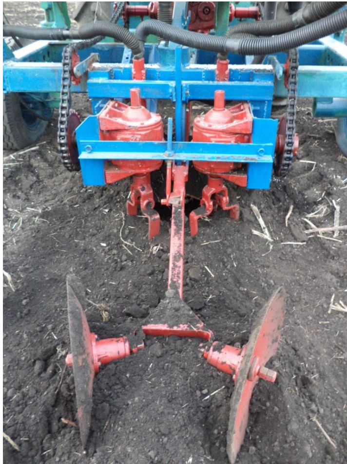
Рисунок 3.3 – Формирование опытным образцом агрегата гребневидного почвенного фона
