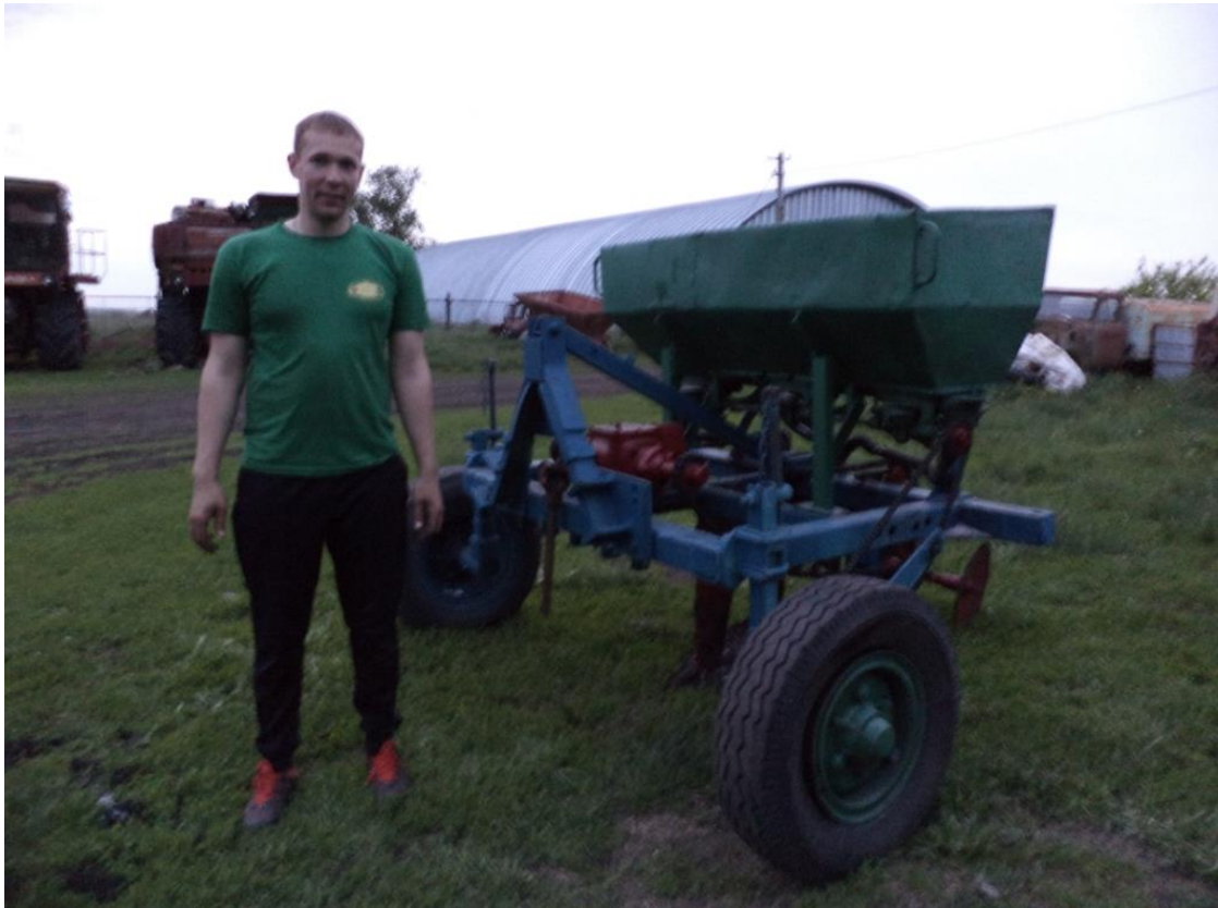
Рисунок 3.1 – Опытный образец агрегата для формирования гребневидного почвенного фона с дифференцированным распределением удобрений
